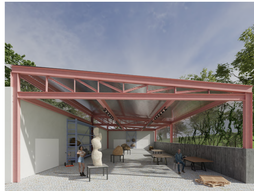
venkovní dílny - adaptace stávající galerie přidaná konstrukce přístřešku pro venkovní provoz dílen
