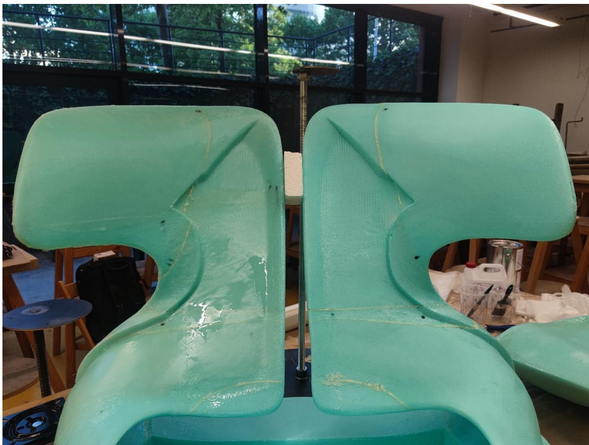
Obrázek 51: Rozdíl mezi laminovanou (vlevo) a nelaminovanou (vpravo) částí, 2024
