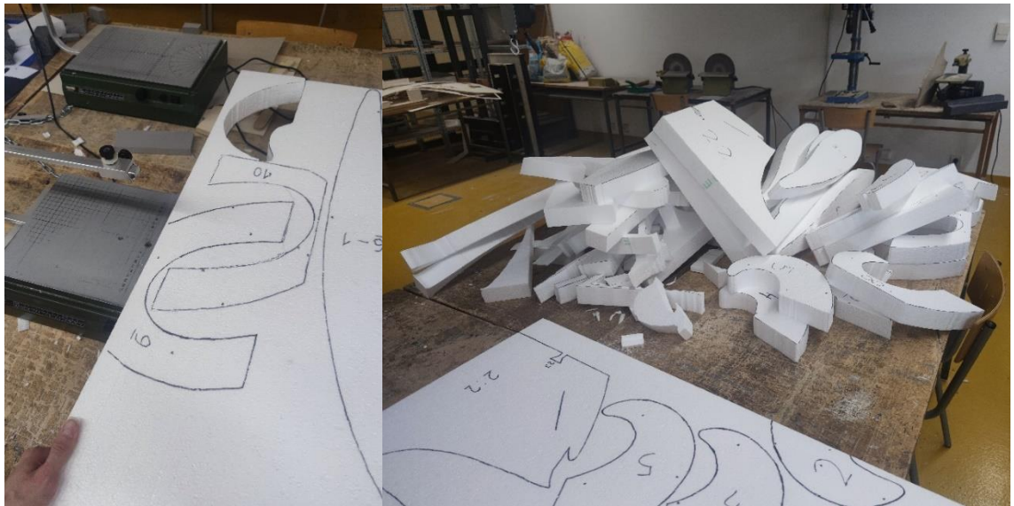
Obrázek 58: Proces vyřezávání polystyrenových "vrstevnic" pomocí horkého drátu, 2024
