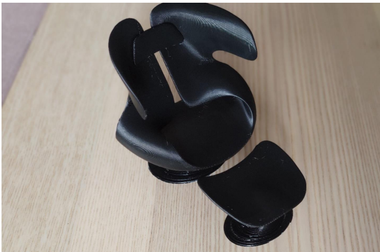
Obrázek 35: 3D zkouška před finalizací v měřítku 1:10, 2024
