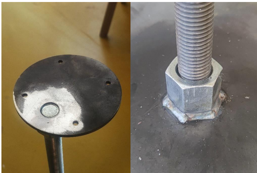
Obrázek 48: Detail svarů – středové matice jsou navařeny ze dvou stran pro zajištění pevnosti v ohybu, 2024
