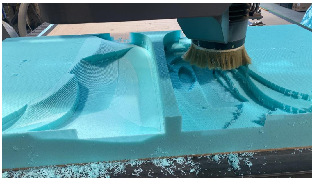
Obrázek 40: Kryštof Jinek, Frézování XPS pěny na CNC stroji, 2024
