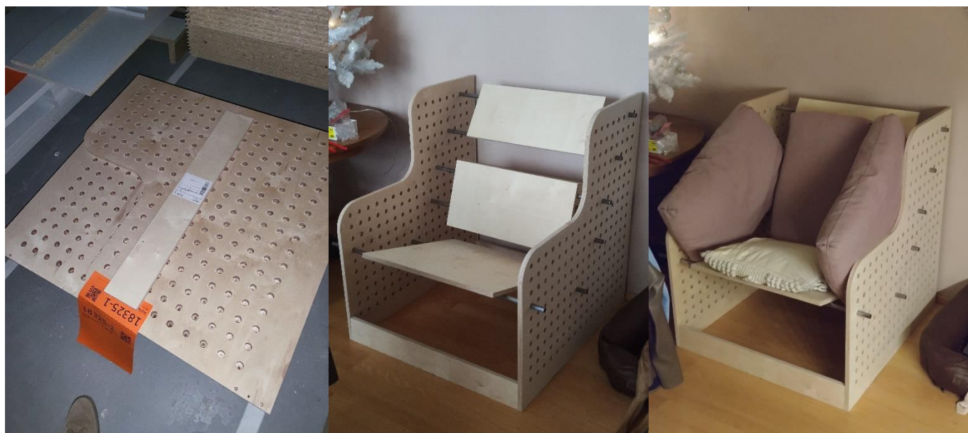
Obrázek 57: Testovací zařízení – překližka 18 mm s vyvrtanými otvory pro pozicování ocelových trubek a dosažení potřebných úhlů a výšek sedáku, zádočné opěrky a lumbální opěrky, 2023
