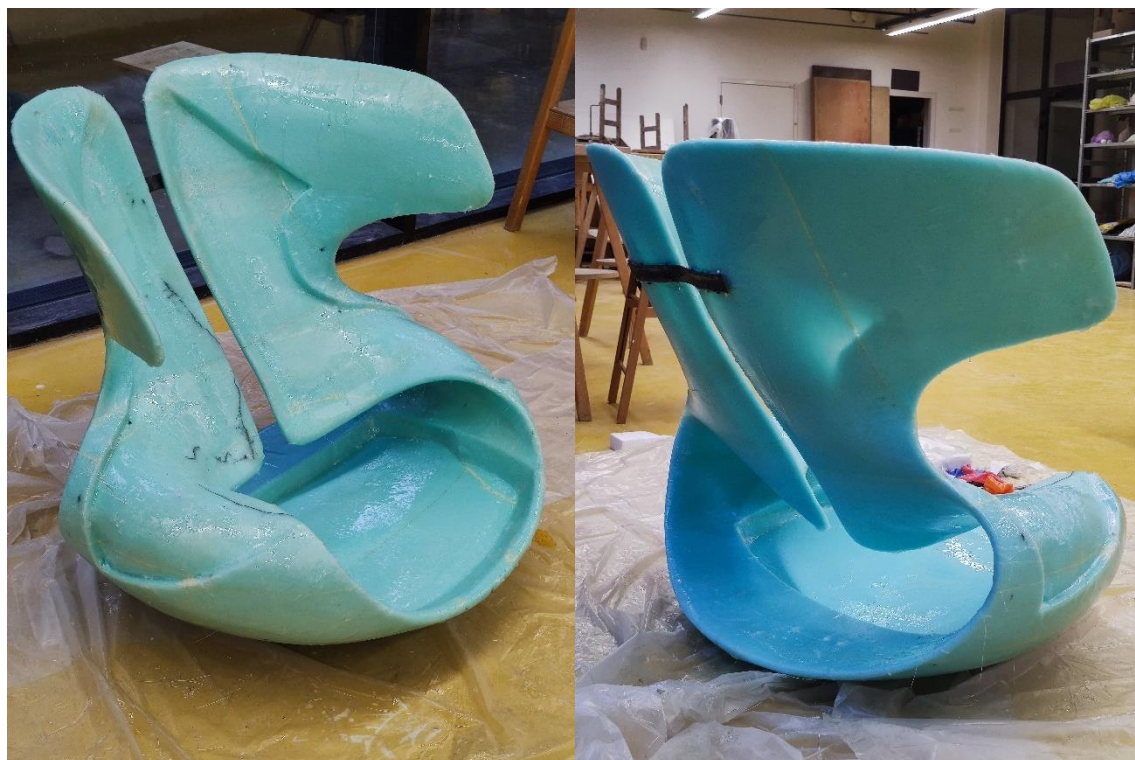
Obrázek 52: Kompletně laminovaný korpus křesla, 2024
