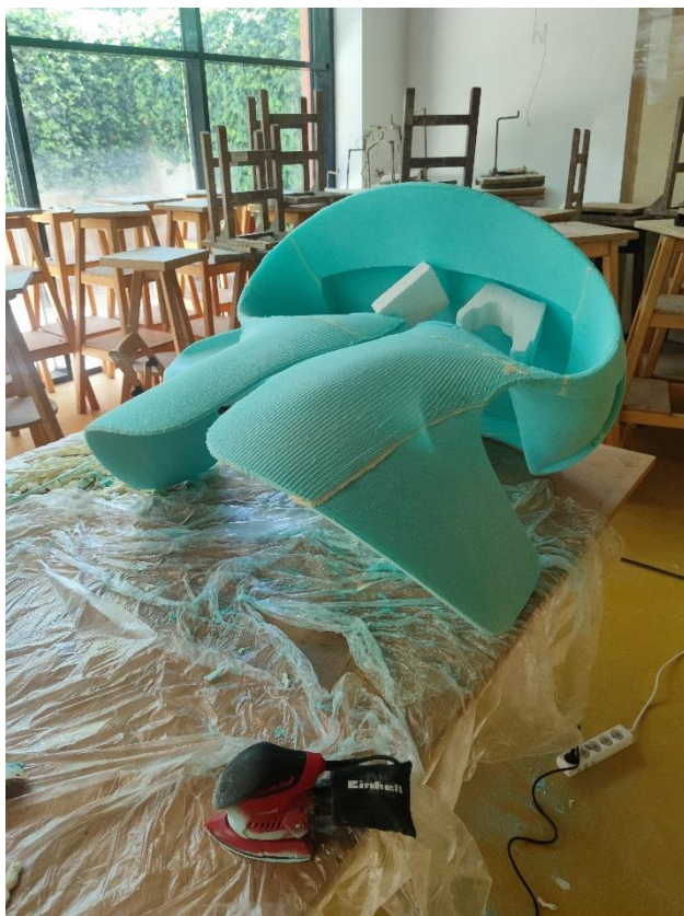
Obrázek 44: Proces broušení jádra před laminací, 2024
