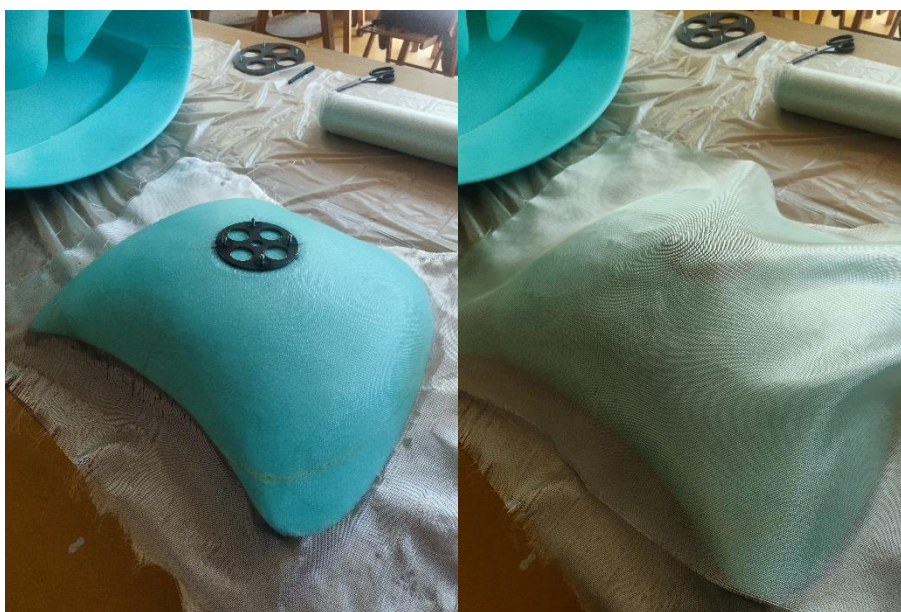
Obrázek 53: Proces vlepování kotevních protikusů, 2024
