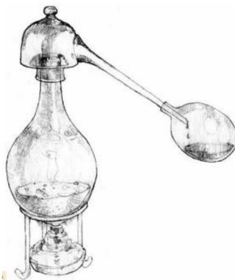
Obr. 2: Alembická destilační kolona využívaná Jabir Al Razim
