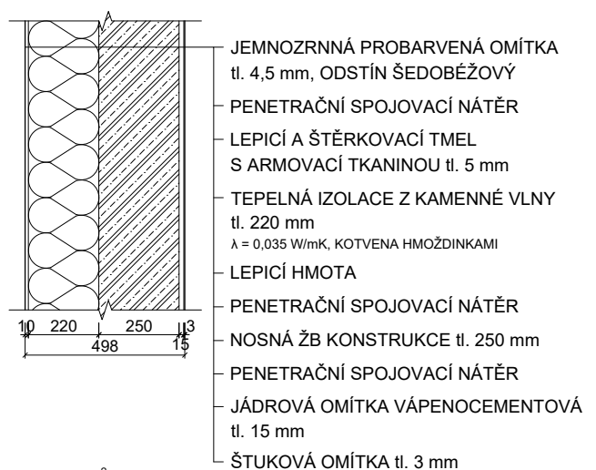
SKLABA S01 OBVODOVÁ STĚNA NOSNÁ
