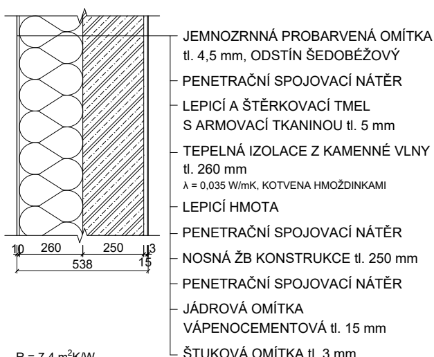
SKLABA S02 OBVODOVÁ STĚNA NOSNÁ V 1NP
