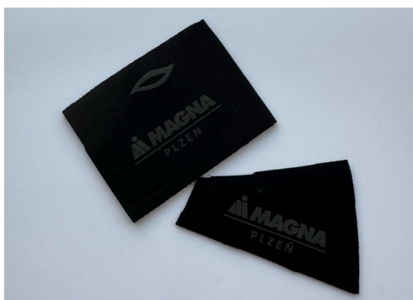
Obr. 54: Zkouška potisku černou reflexní fólií
