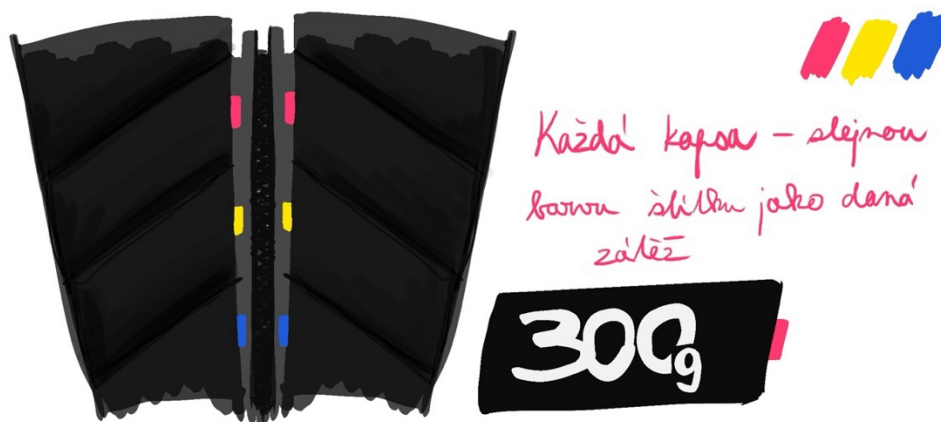
Obr. 37: Rozlišení vkládacích závaží
