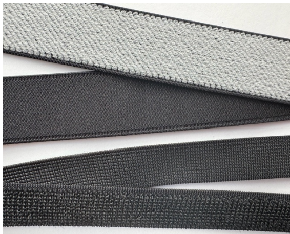
Obr. 22: Pruženka a elastický suchý zip
