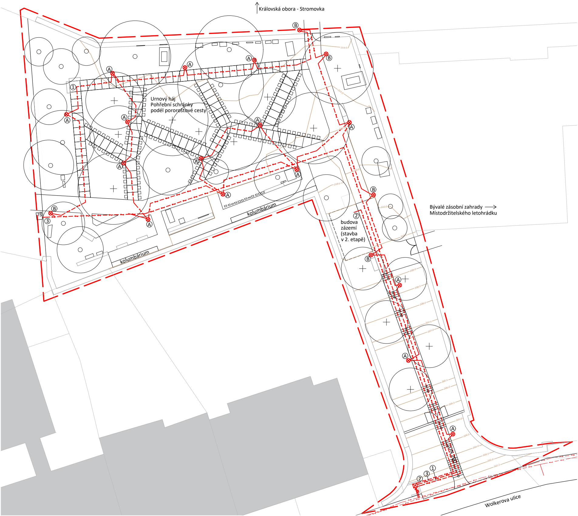
A Svítidlo veřejného osvětlení - Zahradní stojací LED svítidlo z betonu 15 kusů
