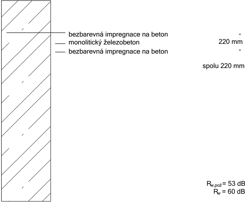
S2 ŽELEZOBETONOVÁ STĚNA 220 mm
