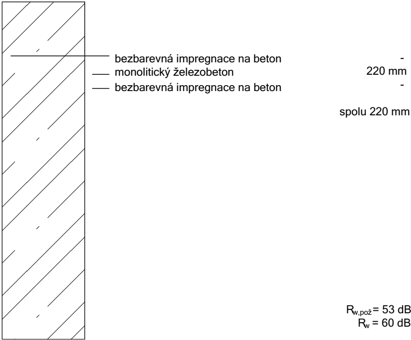
S2) ŽELEZOBETONOVÁ STĚNA 220 mm
