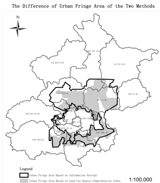
FIG 1 --- Priestorová definícia UKR vyhotovená pomocou GIS dát (Land use a Land Cover) a matematického výpočtu Zdroj / Autor: Wang, X., Li Xuerui, Feng Zhongke, FangYuan, (2009), Methods on defining the urban fringe area of Beijing , SPIE Proceedings, Volume: 7840, Pages: 518-526. Sep 26, 2009
