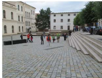
Obrázek 138 – snížení terénu o 30 - 50 cm – převládá pro- pojení úrovní; 50 - 150 cm – výrazné oddělení prostorů, ale zároveň významná vazba mezi nimi; Broumov 10
